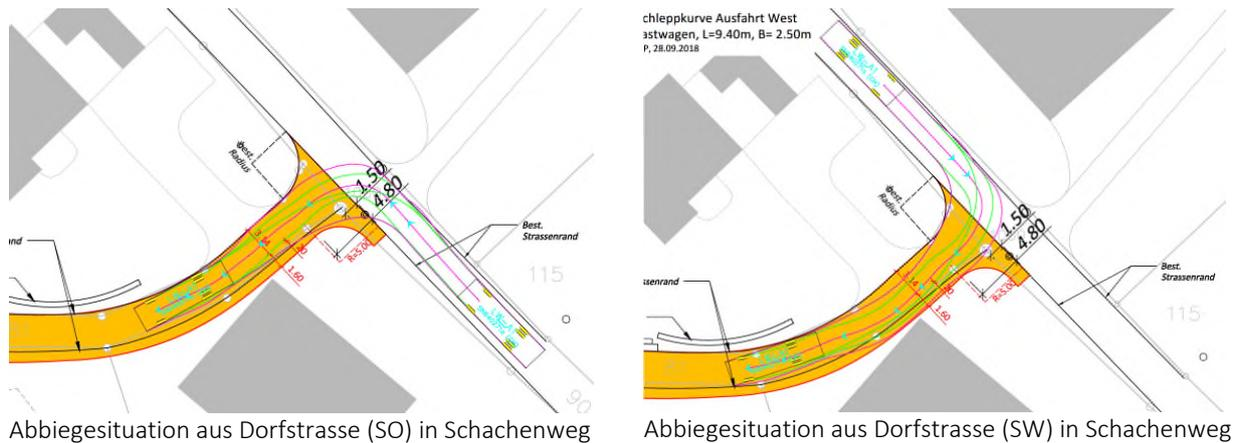
Abbildung 13 Überprüfung Knoten Dorfstrasse/Schachenweg mittels Schleppkurven
